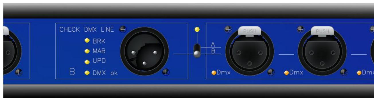
Выбор варианта коммутирования входов/выходов производится тумблером на лицевой панели, согласно ниже приведенной схеме.
